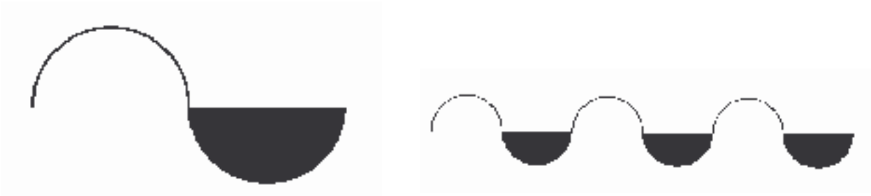
Abb.: Ein Ton ist eine periodische Schwingung. Musik ist ein Klang mit periodischen Schwingungen.
